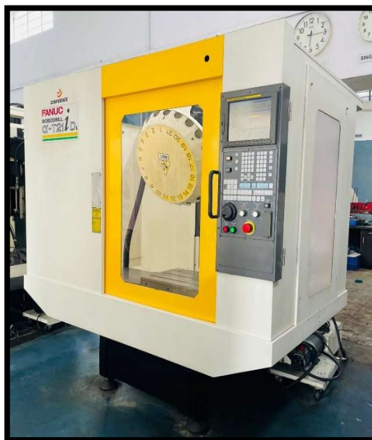
Vista do centro de usinagem vertical de alta precisão, modelo: Robodrill a-T21iDL.
